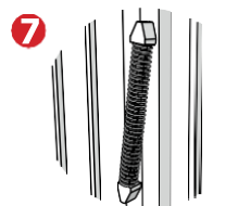
Exemple de ressort permettant la fermeture et le verrouillage automatique de la porte
